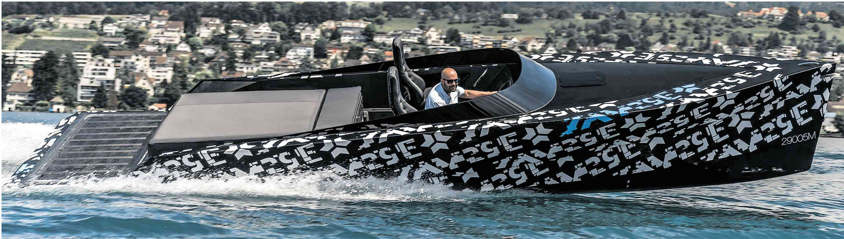
Elektrisch Tempo machen: Statt eines V8-Motors von Ilmor mit 7,4 Liter Hubraum und 480 PS bringen die Strom-Variante zwei gekoppelte E-Motoren mit insgesamt 314 Kilowatt oder 421 PS Leistung auf Fahrt
