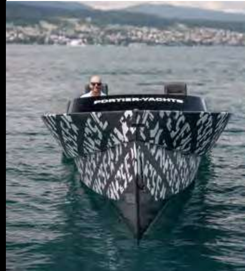
Der charakteristische Wavecutter-Bug und die Sidewings sollen für maximale Stabilität sorgen und „höchste Kurvengeschwindigkeiten“ ermöglichen. Das Handling des Boots, das im deutschen Wagnen produziert wird, soll „faszinierend einfach“ sein, auch in der Welle.
