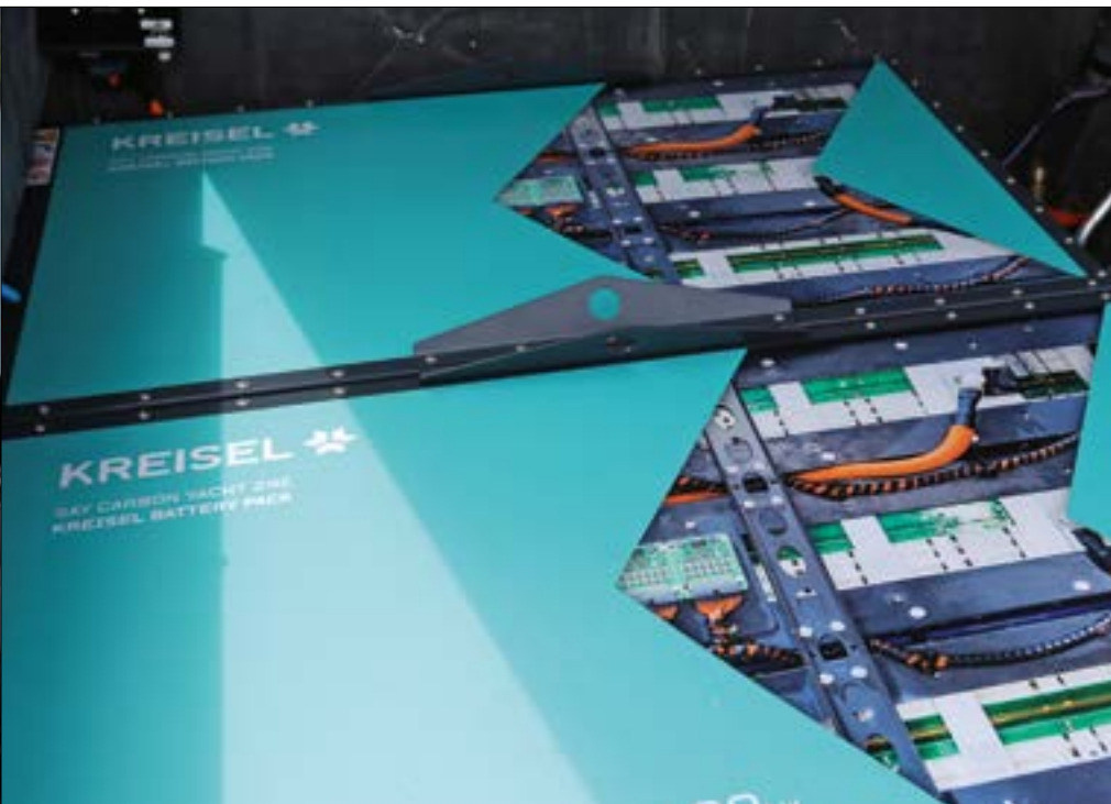
Belastbar. Die Batterien von Kreisel sind federnd gelagert, jede Zelle ist von einer nicht leitenden Flüssigkeit umgeben. Gut gefedert sitzt auch die Crew und für die riesige Sonnenliege gibt's ein Beschattungssystem mit Karbonstangen
